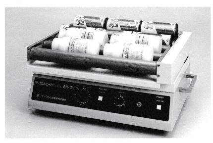
バリウムゾルのビン又は缶の沈澱物を短時間で均一にします。 また、大量に掛けられますので集団検診車での使用にも最適です。
